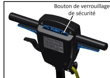
Une fois que vous avez la hauteur de la poignée réglé selon vos préférences et vous êtes dans la position des opérateurs, regarder à droite sur la base de la machine. Vous verrez l'indicateur de démarrage neutre qui indique avec la base de la machine est de niveau en alignant la bulle entre les deux lignes. Appuyez sur le bouton de verrouillage de sécurité avec vos pouces et démarrez la machine en appuyant soit à gauche, à droite ou de préférence les deux leviers de commutation.
