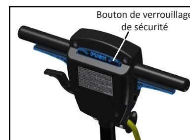
Une fois que vous avez la hauteur de la poignée réglé selon vos préférences et vous êtes dans la position des opérateurs, regarder à droite sur la base de la machine. Vous verrez l'indicateur de démarrage neutre qui indique avec la base de la machine est de niveau en alignant la bulle entre les deux lignes. Appuyez sur le bouton de verrouillage de sécurité avec vos pouces et démarrez la machine en appuyant soit à gauche, à droite ou de préférence les deux leviers de commutation.
